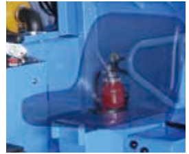
消火器 (シート後部)
